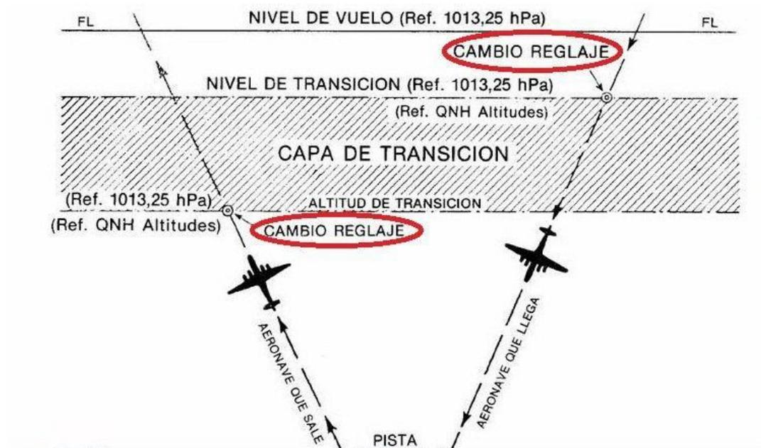
Figura 4. Cambio de reglaje de presión ascenso y descenso.
